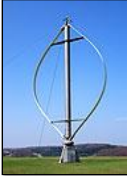
شكل (٣) توربين رياح محور رأسي
